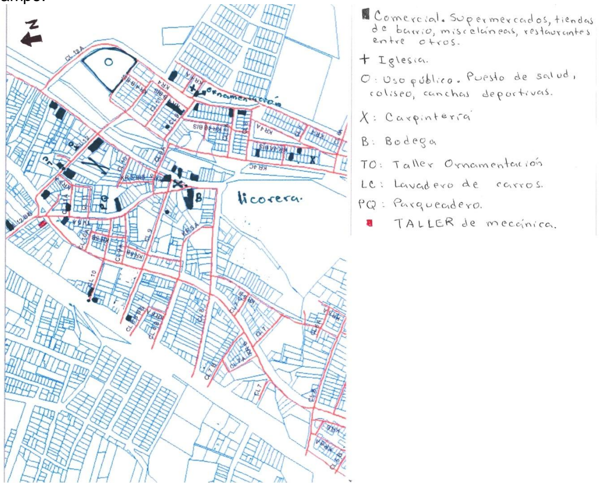
Figura 11. Escáner mapa usado para recolectar la información de uso predial en campo.
