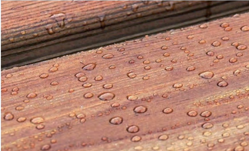
FIGURA 5: Goccioline d'acqua su legno reso impermeabile dal trattamento.
