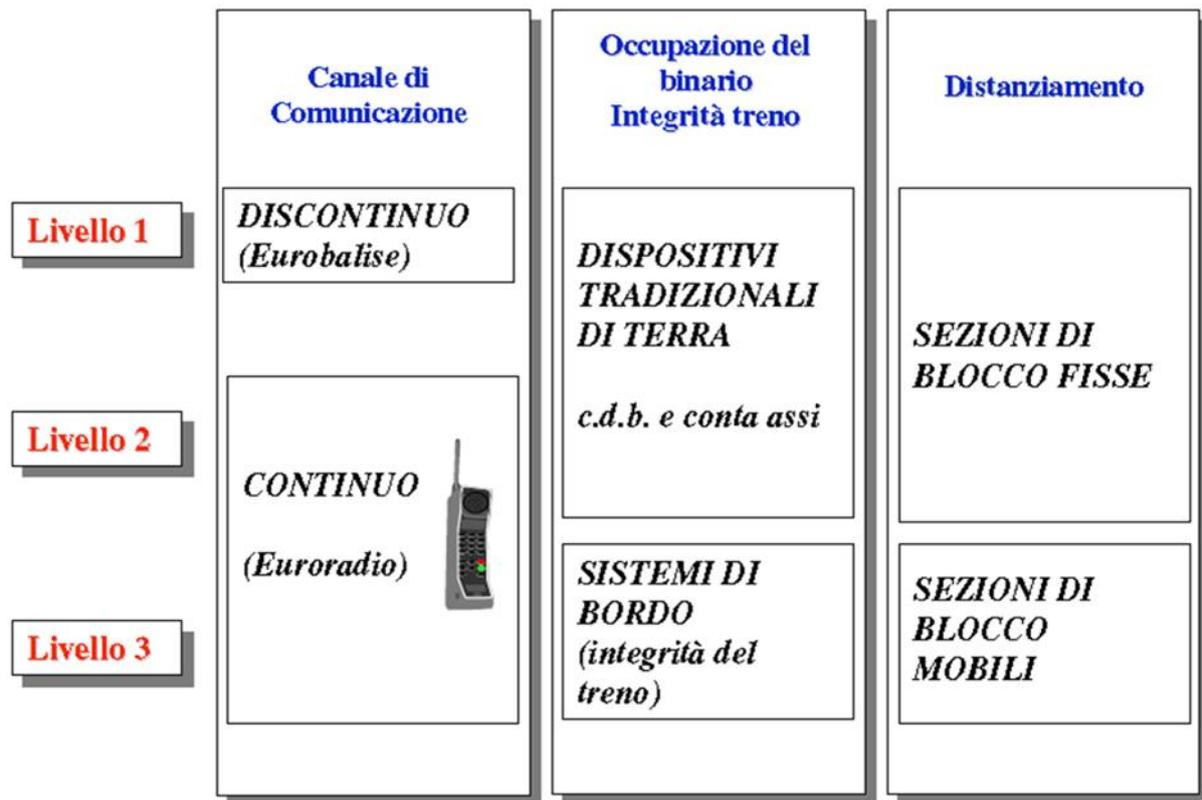
Fig.7 - Gestione, controllo e protezione circolazione dei treni ERTMS: (European Railway Traffic Management System)
