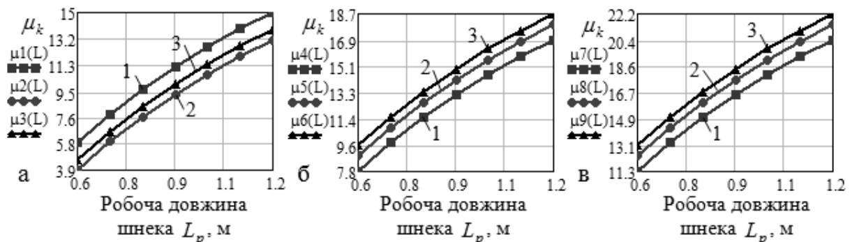
Рис. 7. Залежність зміни коефіцієнта подрібнення \mu_k коренеплодів
