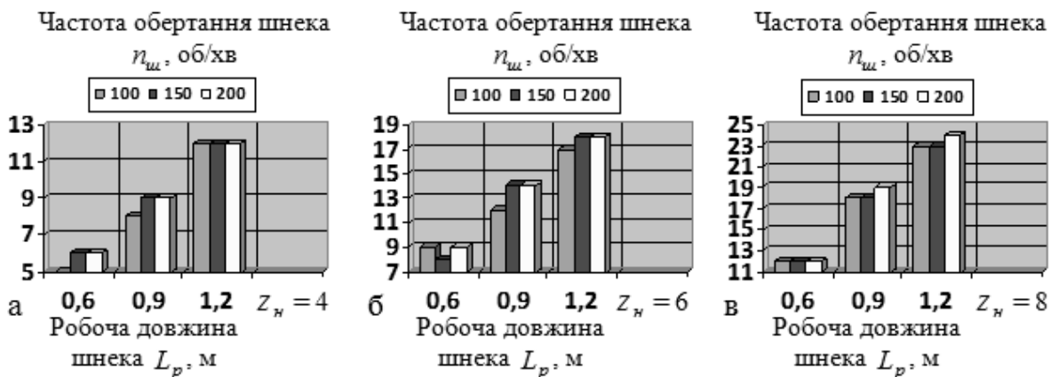
Рис. 9. Діаграма зміни коефіцієнта подрібнення \mu_k коренеплодів: а, б, в – z_n = 4, 6, 8 шт.
