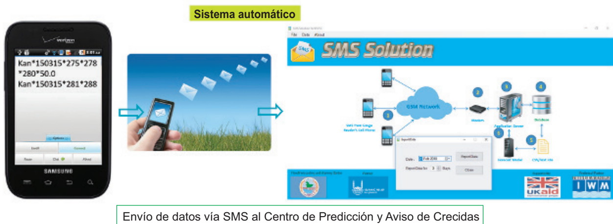
Figura 2. Transmisión de datos a través del sistema de mensajería SMS
