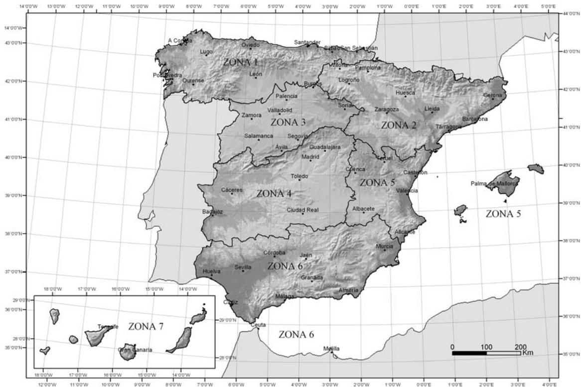
Fig. 5: Zonas para la determinación de los valores característicos de carga de nieve  $s_k$  [ $\text{kN/m}^2$ ], en función de la altitud geográfica [m]
