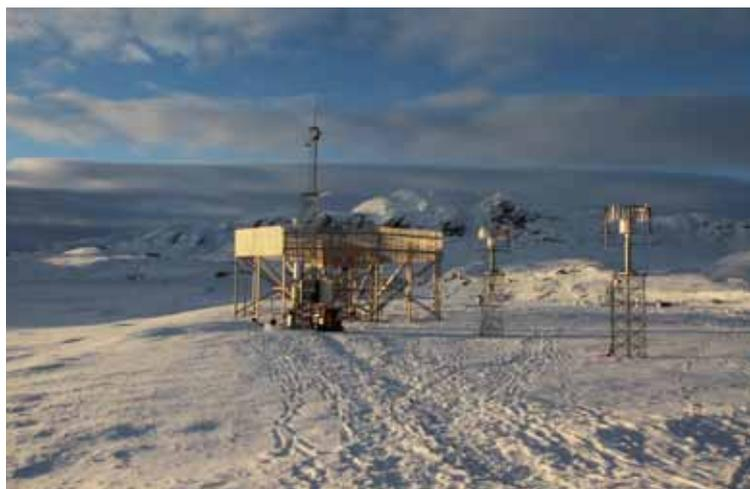
**Sistema de referencia SPICE utilizando sistemas automáticos (Haukelisetter, Noruega, 990 m). Un pluviómetro automático se sitúa en el interior del DFIR (doble vallado de madera) Mareile Wolff, Norwegian Meteorological Institute**
