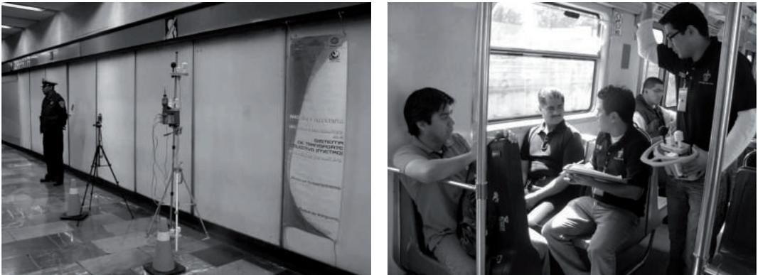
FIG. 2: *Equipo de medición y encuestas de confort térmico humano en el Metro.*
