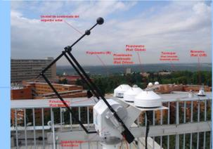
Sensores en una Estación Radiométrica completa de AEMET
