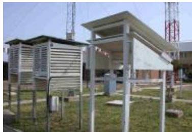
Fig. 1. Imágenes panorámicas y de detalle de la réplica experimental del abrigo Montsouris en A Coruña y Murcia. a) Vista general de la instalación en A Coruña. b) Vista frontal del abrigo Montsouris en A Coruña. c) Vista lateral del abrigo Montsouris en Murcia. d) Vista panorámica de la instalación en Murcia
