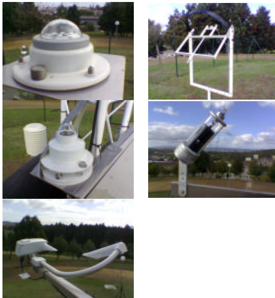
Fig. 4.- Equipo auxiliar de la EOAS. De izquierda a derecha y de arriba abajo: Piranómetro Ph Schenk 8101 clase A, Piranómetro Ph Schenk 8101 clase A con banda de sombra, Piranómetro Biometer 501A Solar Light, Medidor de horas de sol CSD1 Kipp & Zonen, Medidor de Visibilidad PWD20 Vaisala
