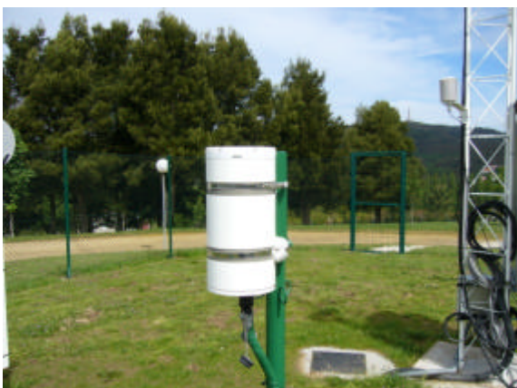
Fig. 3-b.- EOAS: Instalación del radiómetro GUV 2511
