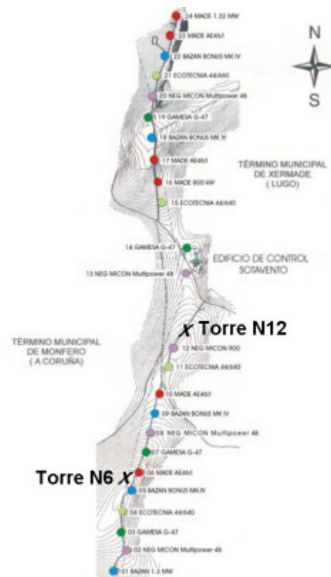
Fig. 1.- Plano del parque eólico Sotavento mostrando la situación de los aerogeneradores y las torres anemométricas.
