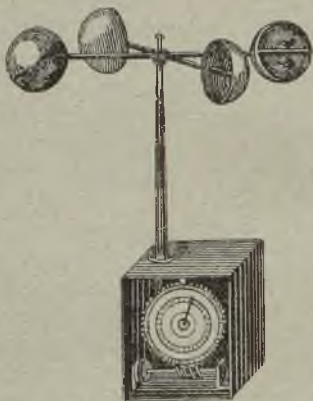
Fig. 22. — Anemómetro de Robinson.
