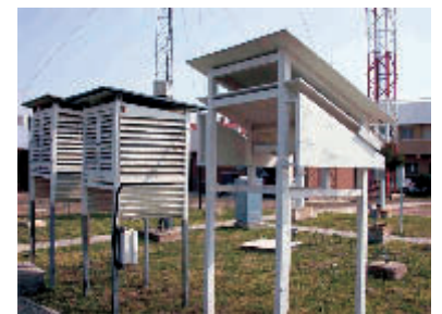
Figura 1. Imágenes panorámicas y de detalle de la réplica experimental del abrigo Montsouris en A Coruña y Murcia. IZQ., vistas generales de las instalaciones de A Coruña (arriba) y Murcia (abajo). CENTRO, vista lateral del abrigo Montsouris en Murcia. DCHA, detalle de los dos abrigos de la instalación de A Coruña.
