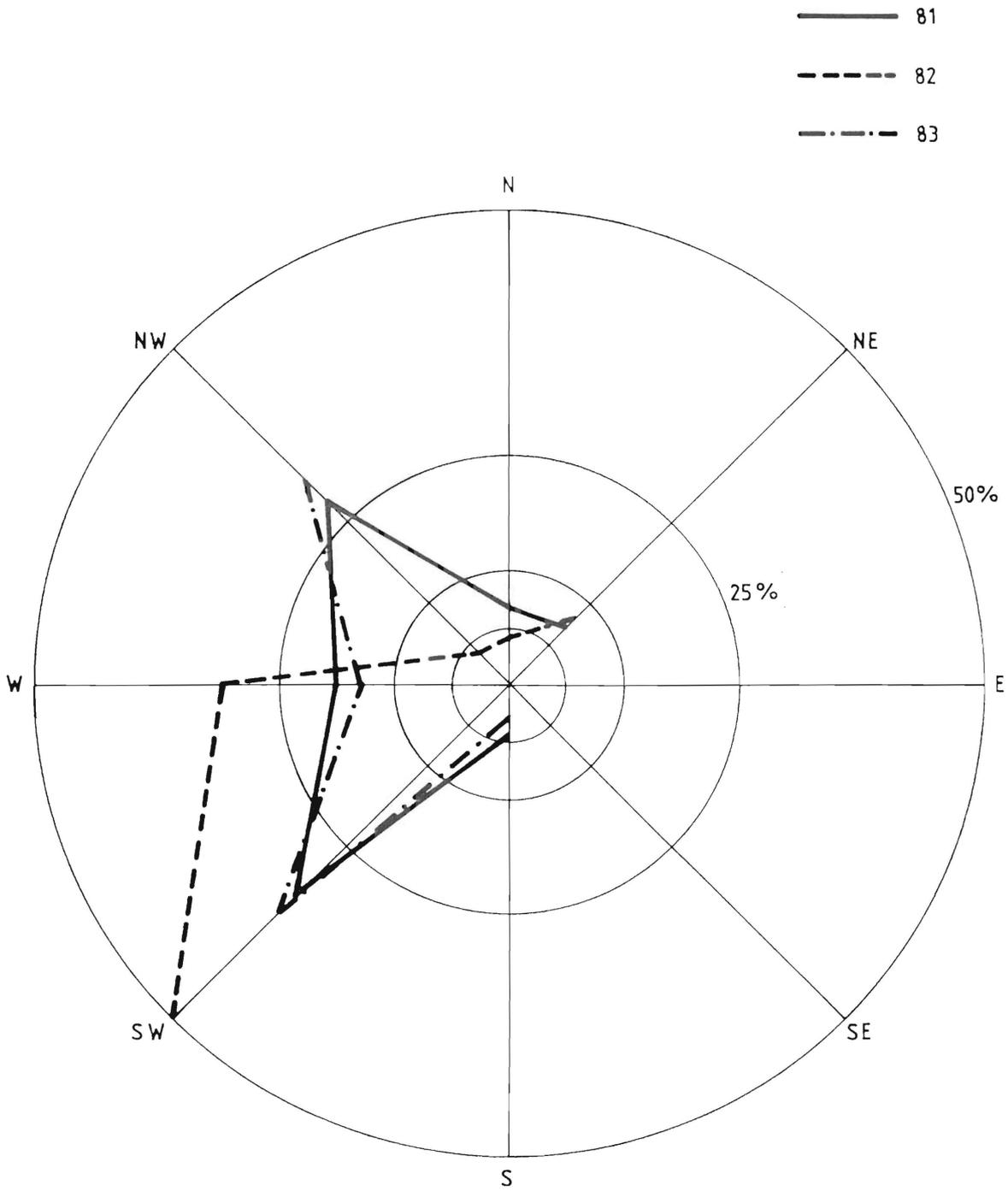
Figura 2: Diagrama porcentual de la variable dirección del viento.
