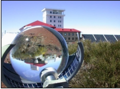
Figura 5.9.- Heliógrafo Campbell-Stockes instalado en la estación de Izaña.
