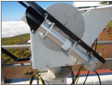
Figura 1.13.- Pirheliómetro Kipp & Zonen modelo CH-1 para la medida de la radiación directa instalado en la estación BSRN de Izaña.
