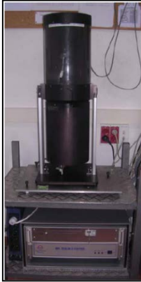
Figura 4.5.- Imagen del LIDAR micropulsado MPL: MPL-3 instalado en la estación de SCO (Fuente: INTA).
