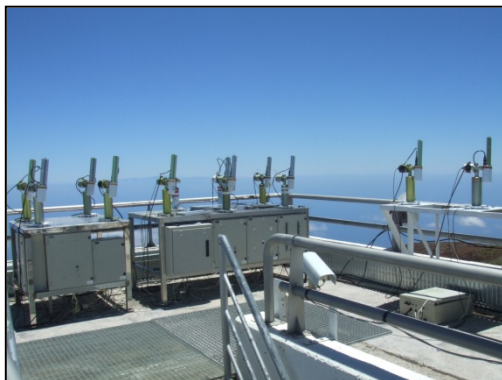
Figura 4.2.- En la figura de la izquierda tenemos los fotómetros CIMEL de las redes PHOTONS/RIMA/AERONET instalados en el OAI. En la figura de la derecha tenemos la serie de AOD a 500 nm medida en la estación de Izaña durante el período 2006-2010.
