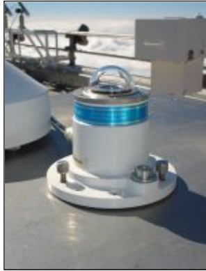
Figura 1.15.- (a) Piranómetro Yankee UVB-1 instalado en la estación BSRN de Izaña. (b) Respuesta espectral relativa del piranómetro Yankee YES UVB-1 y el espectro de acción eritemática de la CIE (Fuente: Manual Yankee YES).
