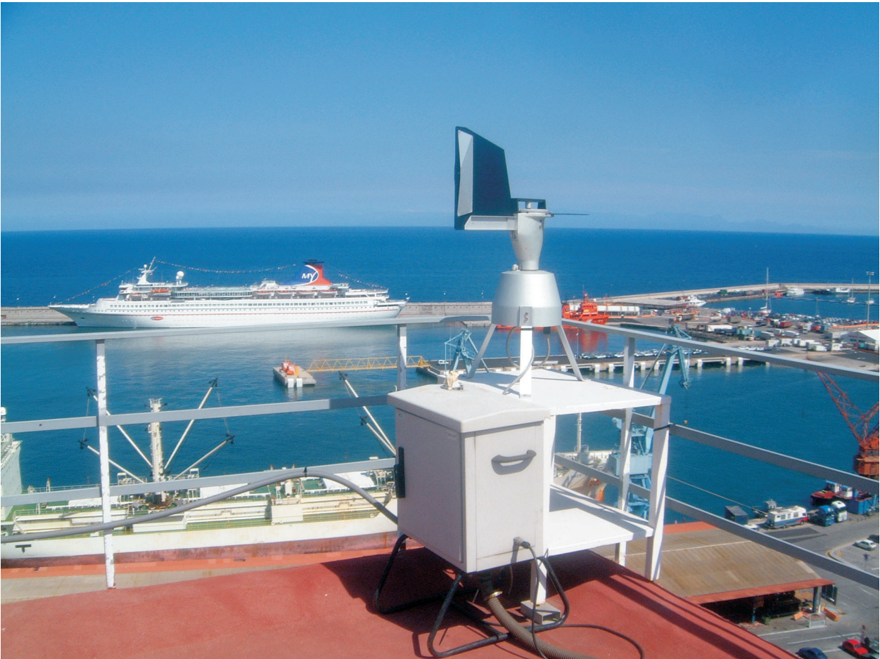
Lámina 3 a. Captador Hirst muestreando en la azotea del edificio donde están ubicadas las oficinas del Centro de Investigaciones Atmosféricas de Izaña, en Santa Cruz de Tenerife.
