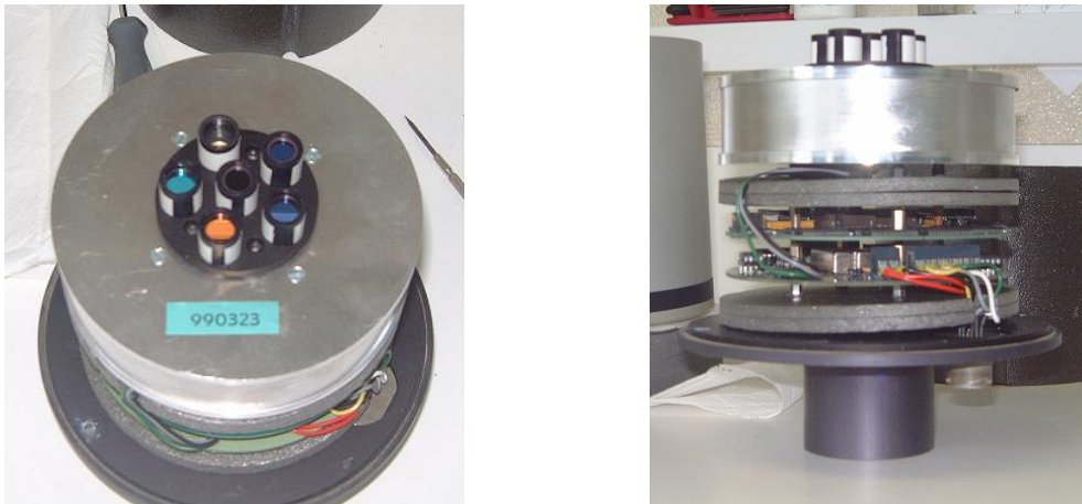
Figura 3.2.- En la Figura de la izquierda podemos ver los 5 canales del rango UV y el canal correspondiente al PAR. En la Figura de la derecha vemos las tarjetas de control y la memoria interna del instrumento.
