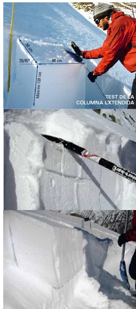
Fig. 75 Test de la Columna Extendida
