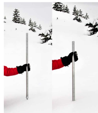
Fig. 35 Hundimiento del primer tubo de la sonda de golpeo
