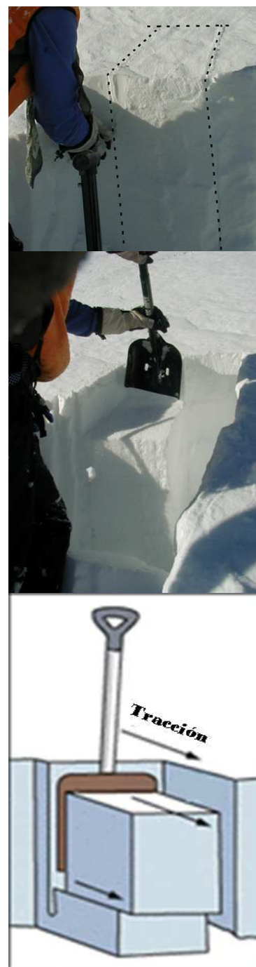
Fig. 73 Test de la Pala.
