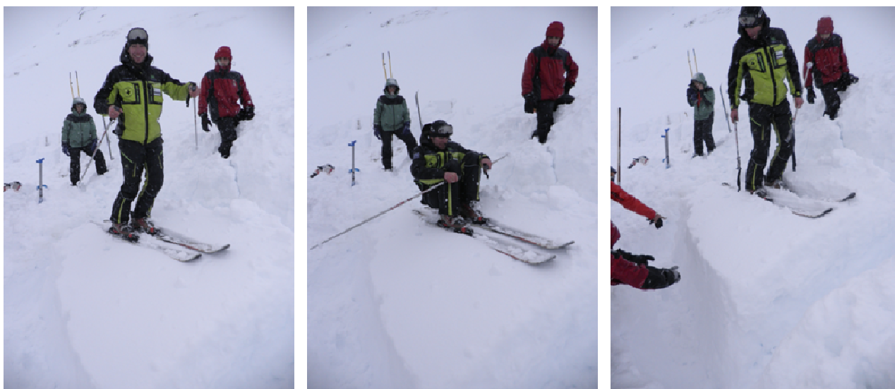
Fig. 77 Test Rutschblock, carga de un bloque
