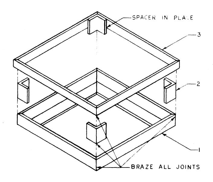
MATERIAL: PART NO. 1  $\frac{3}{4}$  HOT ROLL STEEL ANGLE PART NO. 2  $\frac{3}{4}$  HOT ROLL STEEL ANGLE PART NO. 3  $\frac{1}{2}$  HOT ROLL BAND IRON
