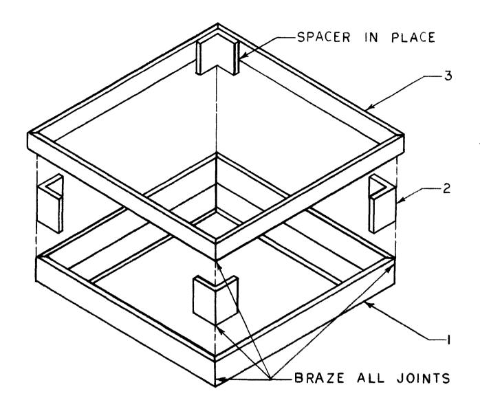
MATERIAL: PART NO. I  $\frac{3}{4}$  HOT ROLL STEEL ANGLE PART NO. 2  $\frac{3}{4}$  HOT ROLL STEEL ANGLE PART NO. 3  $\frac{1}{2}$  HOT ROLL BAND IRON
