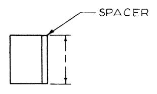
MATERIAL: SPACER \$\frac{3}{4}\$ HOT ROLL STEEL ANGLE
