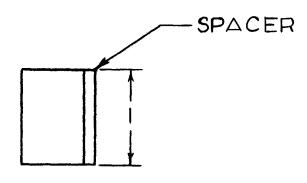
MATERIAL: SPACER \$\frac{3}{4}\$ HOT ROLL STEEL ANGLE BRACE \$\frac{1}{2}\$ HOT ROLL BAND IRON
