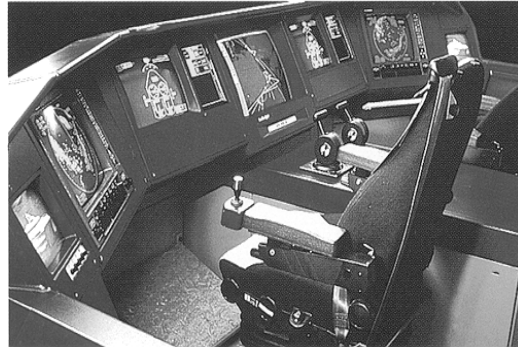
(d) Cockpit - style OMBO bridge.
