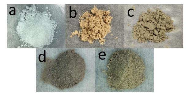
Fig. 2.1 Photographs of pristine  $TiO_2$  (a) and doped  $TiO_2$  samples, (b)  $TiO_2$ -1, (c)  $TiO_2$ -2, (d)  $TiO_2$ -3 and (e)  $TiO_2$ -4.
