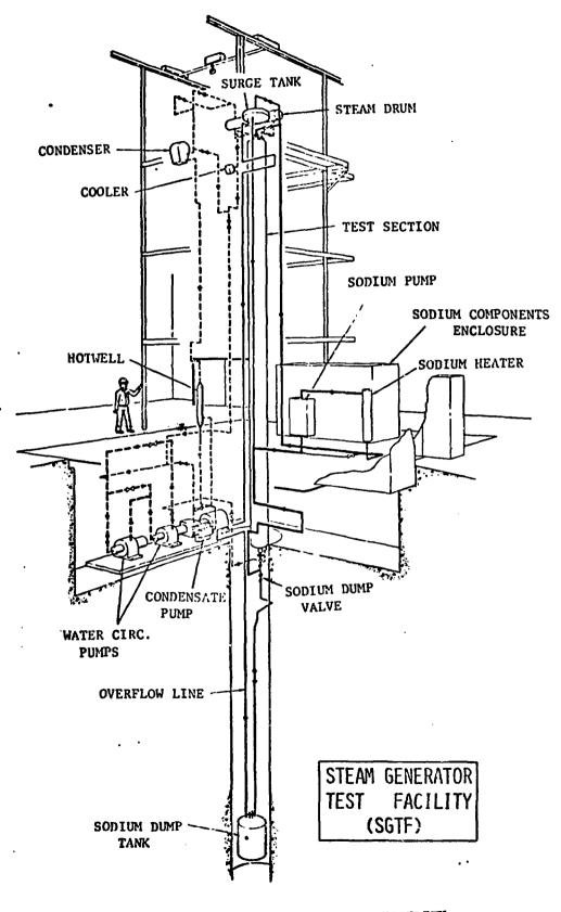
FIGURE 11. STEAM GENERATOR TEST FACILITY (SGTF)
