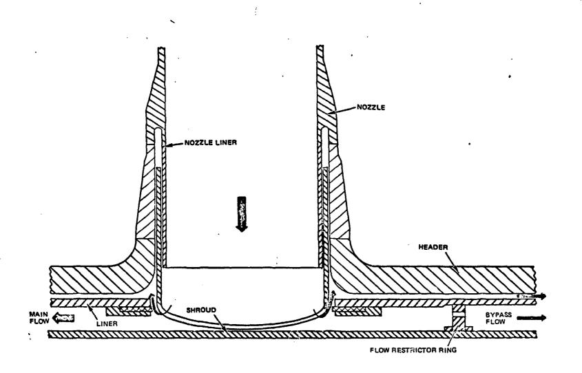
FIGURE 9. ORIGINAL CONFIGURATION OF INLET NOZZLE REGION
