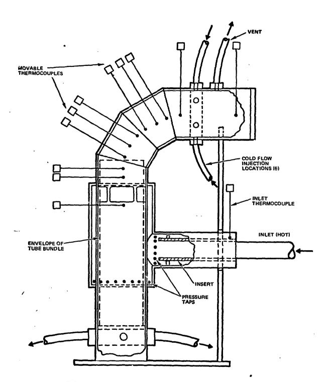
FIGURE 6. HYDRAULIC MODEL OF ELBOW REGION
