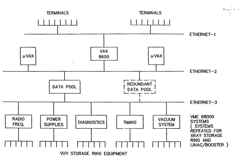
FIG. 1- BLOCK DIAGRAM OF THE NSLS SYSTEM UPGRADE
