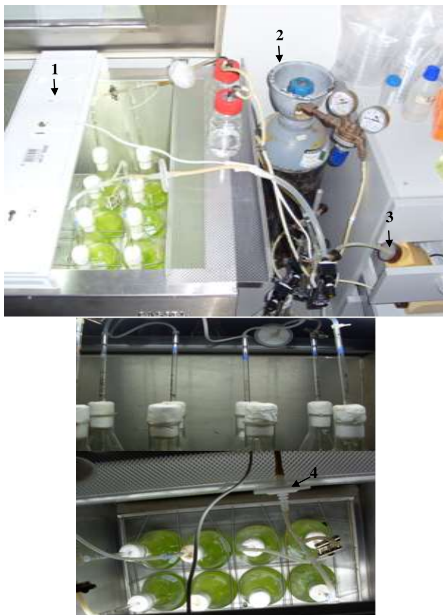
Figura 2.1 – Montagem do ensaio em autotrofia para Chlorella sorokiniana . (1) Lâmpada fluorescente (18 W); (2) Garrafa de dióxido de carbono; (3) Bomba de ar de aquário; (4) Filtro de ar.
