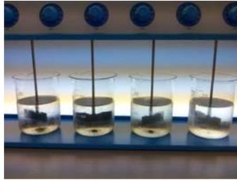
Figura 11 – Fotografia do ensaio “Jar-test” realizado
