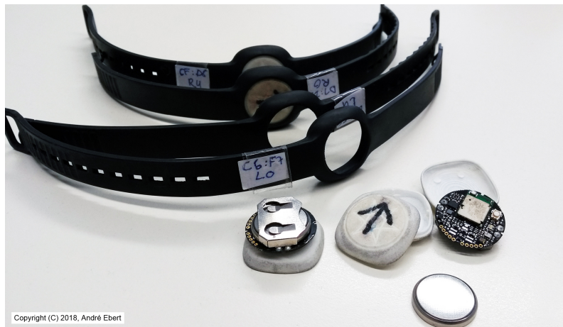
Abbildung 3.3: Abbildung der externen Sensorplattformen mit Schutzhülle und Gummiband zur Befestigung. Zur autarken Energieversorgung dienen handelsübliche CR 2032 Knopfzellen.
