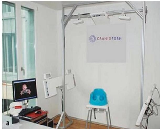
Abbildung 6: Photometrie-Aufnahmeplatz mit 20 Kameras nach Dörhage [2010]
