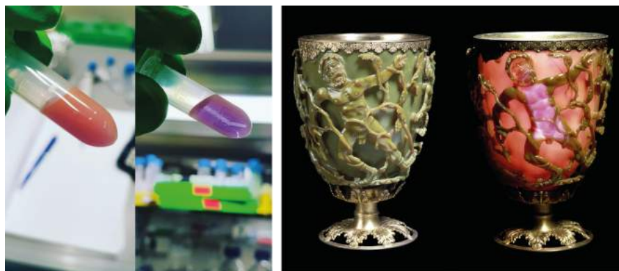
Abbildung 2.3: Links: Zwei Aufnahmen derselben Probe. Das kleine Gefäß enthält Milliarden kleine Goldkugeln (100 nm Durchmesser), die in Wasser schwimmen. Der deutliche Farbunterschied zwischen den beiden Aufnahmen hängt allein davon ab, von wo die Flüssigkeit beleuchtet wird. Im linken Bild kam das meiste Licht von vorne, im rechten das Licht von hinten. Der Unterschied entsteht dadurch, dass bei Partikeln dieser Größe die Lichtstreuung ähnlich stark ist wie die Lichtabsorption. Rechts: Der Lykurgus Becher aus dem 4. Jahrhundert, bei dem man den gleichen Effekt sieht. (British Museum, London published under CC BY-NC-SA 4.0)
