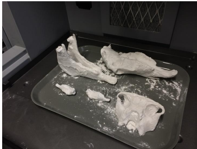
Abbildung 21: Post-Processing-Unit (Absaugbereich) mit Schädel und Unterkiefer vom Araber in 50% und 15% Verkleinerung sowie Transversalschnitt vom Schädel des Esels vor der Pulverentfernung
