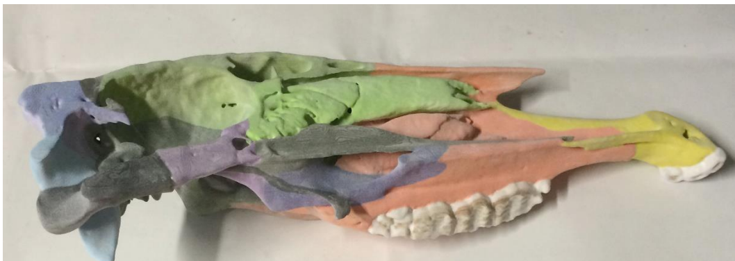
Abbildung 22: Foto vom 3D-Ausdruck des halben Schädels von Equus ferus caballus (adultes Bayerisches Warmblutpferd) nach der Pulverentfernung, aber vor der Infiltration, Verkleinerung 25%
