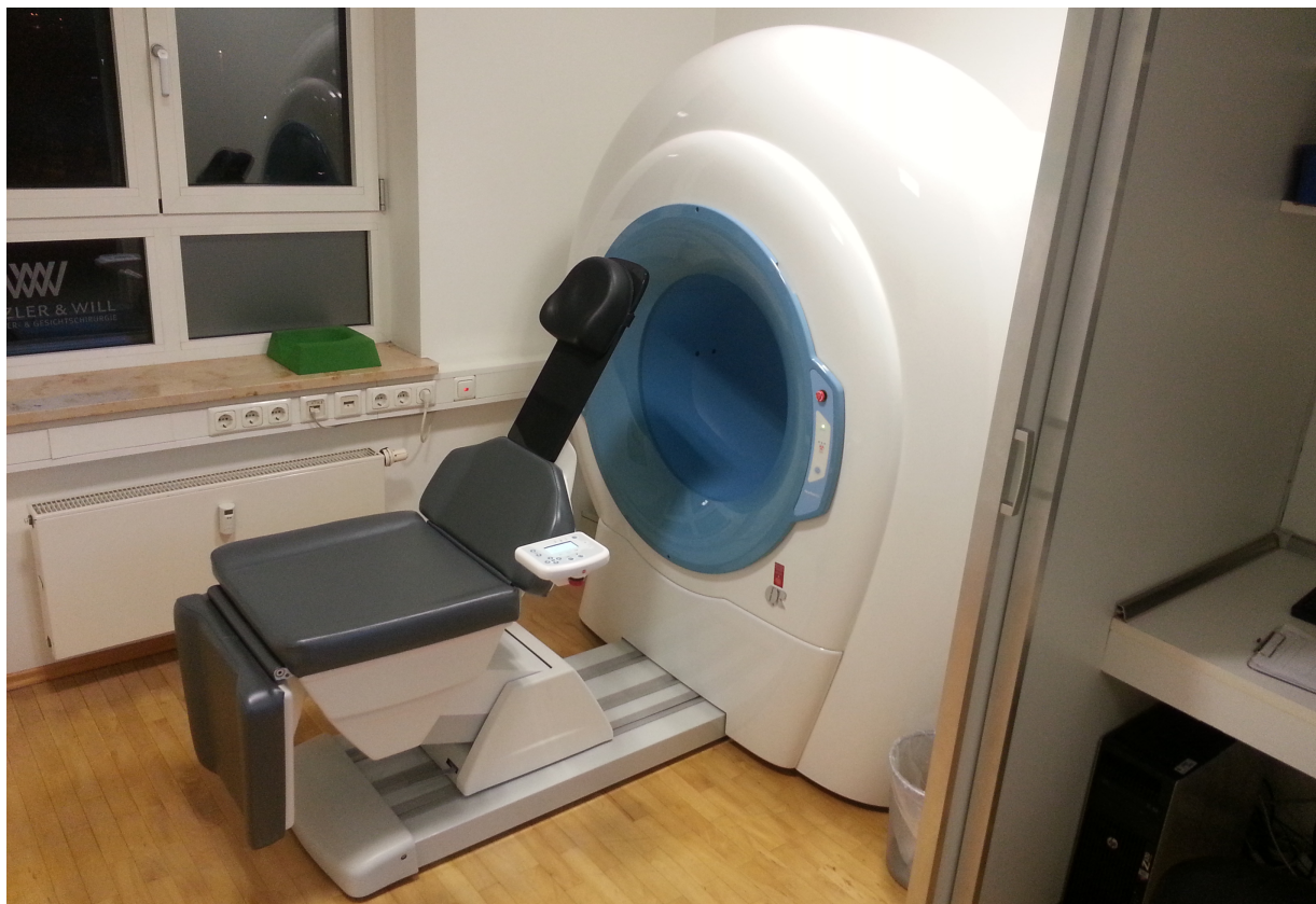
Abb. 4: Beispiel für ein in dieser Studie verwendetes DVT-Gerät, das 5G von NewTom
