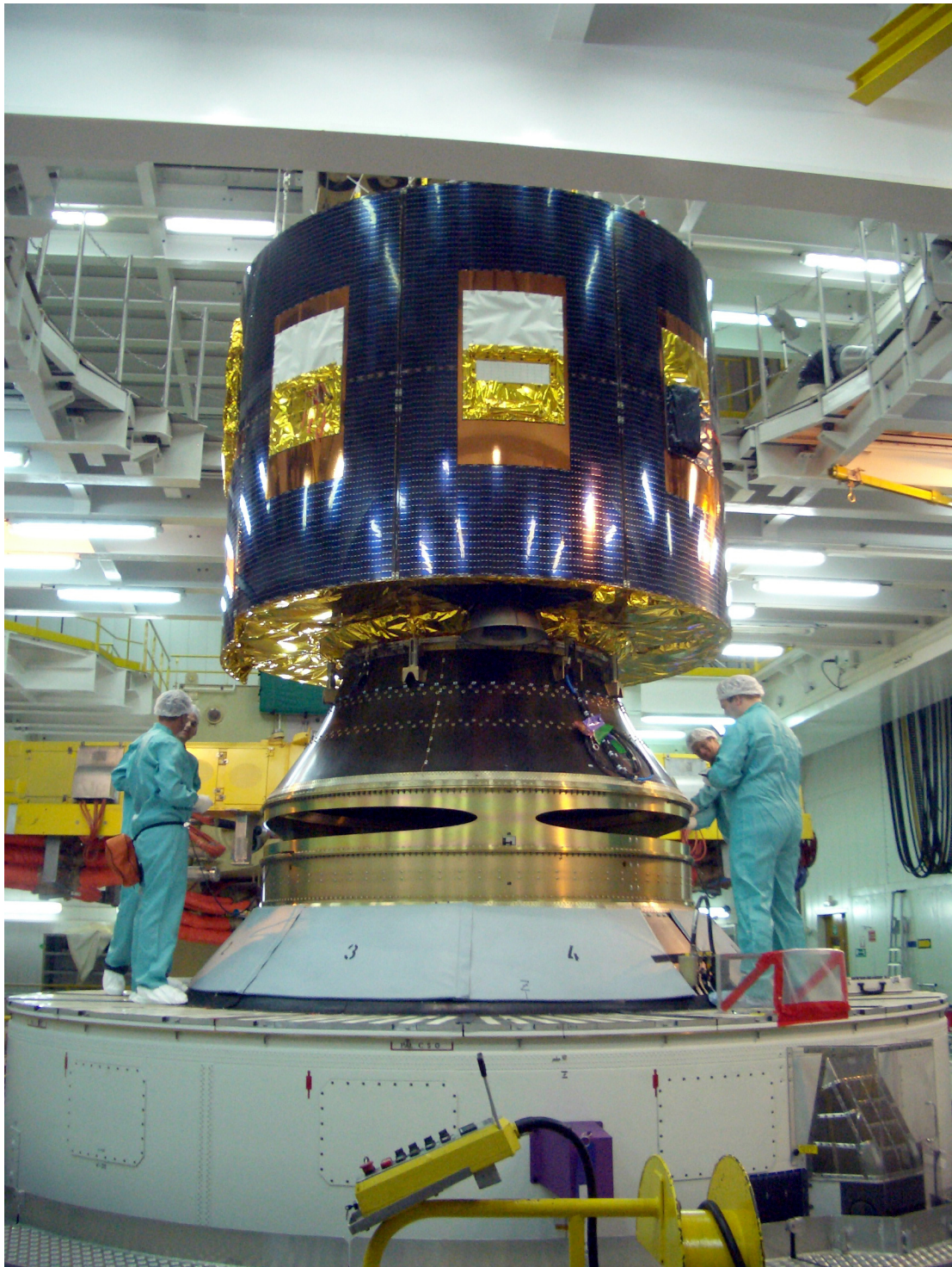
Abbildung 2.3: MSG-2 bei der Installation auf Stoßdämpfern (© ESA/MSG-Team, European Space Agency (ESA), 2005, Abbildung mit freundlicher Genehmigung)
