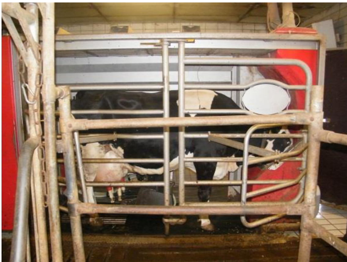
Abb. 3.11.: AMS: Automatisches Melksystem, Lely A3
