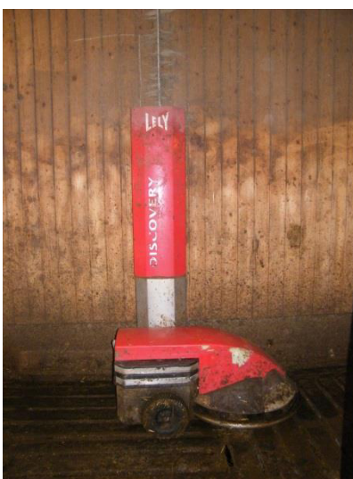
Abb. 3.4.: automatischer Spalten-Roboter Lely Discovery an der Aufladestation
