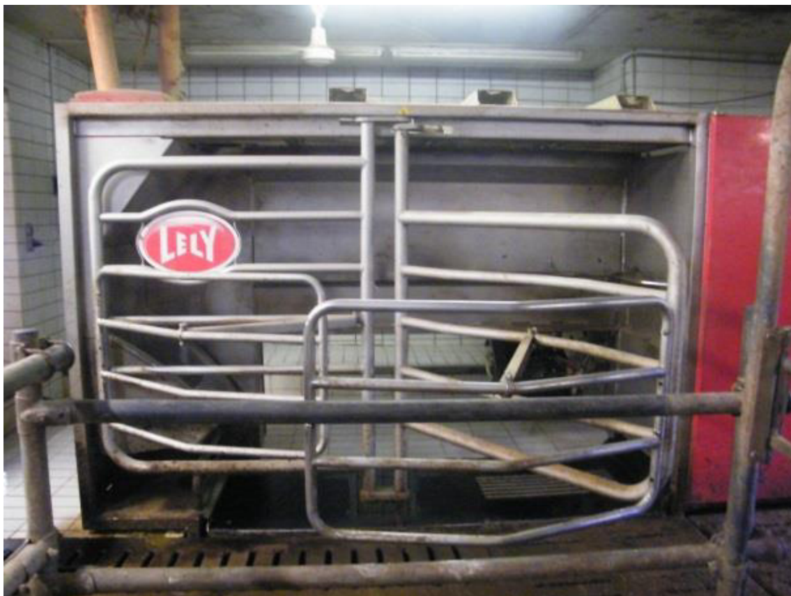
Abb. 3.10.: AMS: Automatisches Melksystem, Lely A3 next
