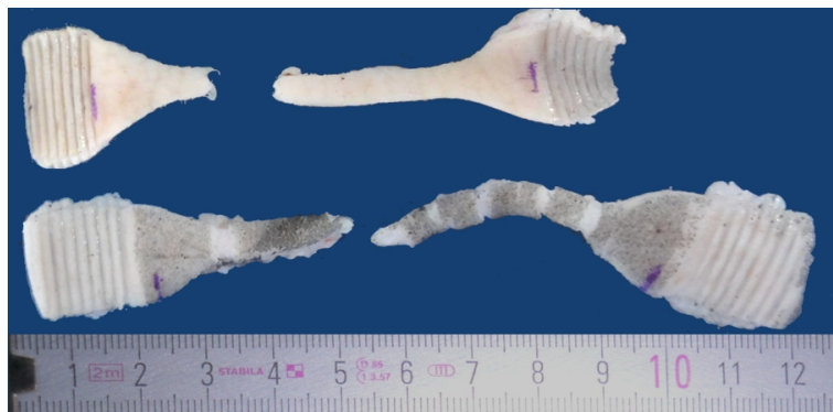
Abbildung 4.25: Hautproben nach dynamischem Zugversuch. Oben: Probe parallel zu den Langerschen Linien: Versagen an einer Stelle in der Mitte der Probe, unten: Probe senkrecht zu den Langerschen Linien: Versagen an mehreren Stellen und deutlich größere Dehnung der Probe, das umliegende Gewebe löst sich von den Kollagenfasern
