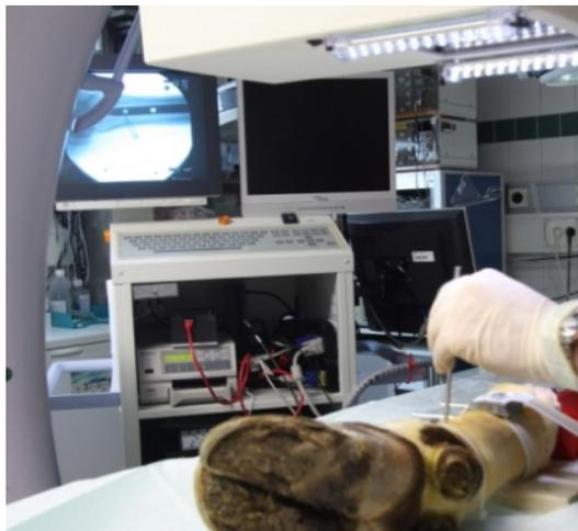
Abb. 9: Experimentelle Studie der Marknagelverriegelung an Rinder-Metacarpi mit deaktivierter Überlagerungsfunktion.
