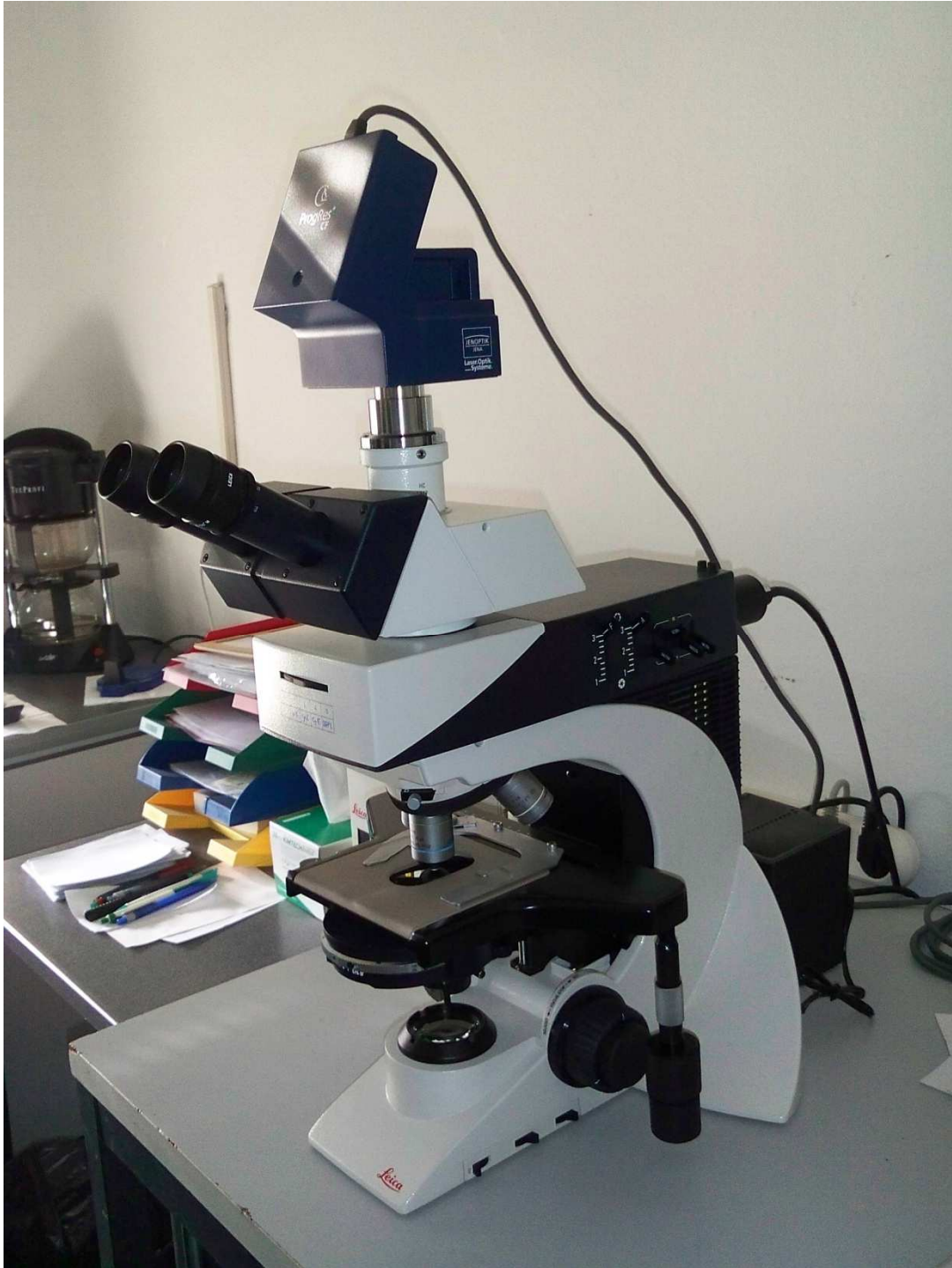
Abb. 9: Fluoreszenzmikroskop von Leica (DM 2500, Leica Microsystems GmbH, Wetzlar) mit Mikroskop-Kamera von ProgRes® CF (Jenoptik Optical Systems, Jena)
