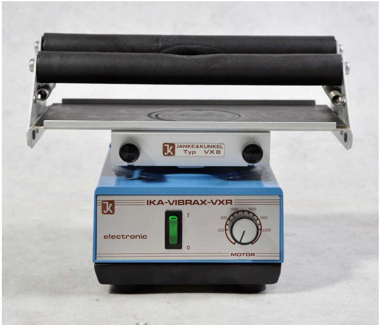
Abb. 11: Rüttler IKA-Vibrax-VXR (IKA-Werke, Staufen)
