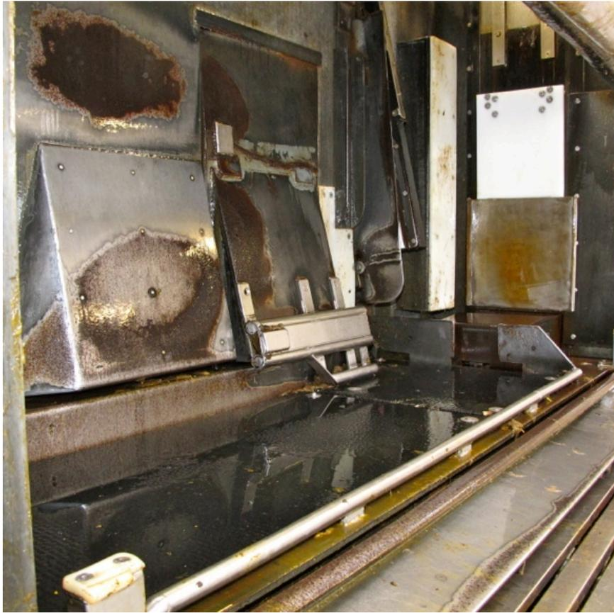
**Abb. 19: Boden direkt nach Reinigung per Kaltwasserstrahl**
