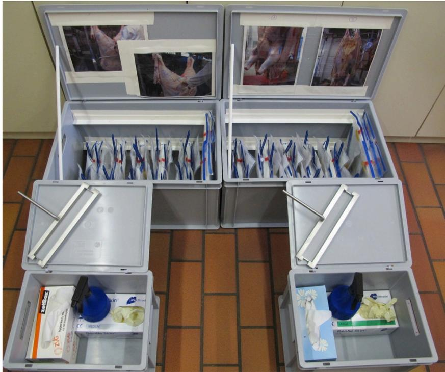
**Abb. 21: Kunststoffboxen und Probenahmematerial**
