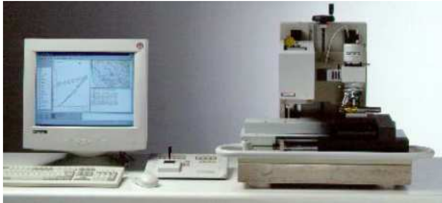
Abb. 3.3.3.-1.: Universalhärtemessgerät (Fischerscope H100C, Fischer, Sindelfingen, Deutschland)
