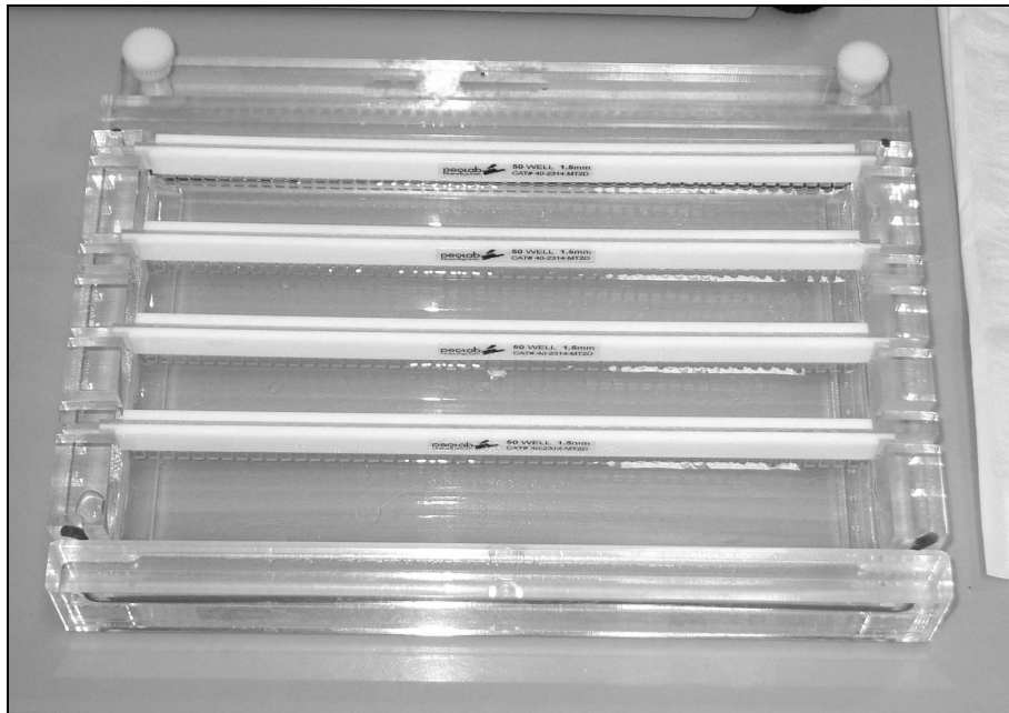
Abb. 22: Sich verfestigende Agarose in Gelkammer mit Kämmen (Bild: C. Hinnerwisch)
