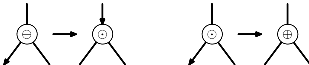
Obr. 12: Vyvažování po zmenšení hloubky levého podstromu vrcholu se znaménkem \ominus nebo \odot .
