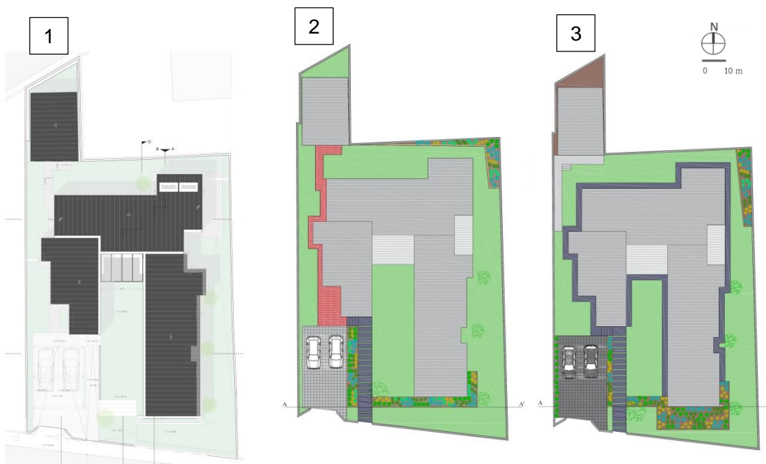
Figura 12 – Evolução do desenho do Plano Geral da Moradia em Albarraque (Fonte: Figura1 – Plano de Implantação sob levantamento topográfico. Arquitecta Isabel Aragão; Figura 2 e 3 - Plano Geral, autor)
