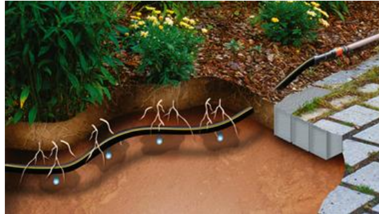
Figura 9 - Esquema representativo do tubo gotejador debaixo do solo (Disponível em: https://www.gardena.com/ )
