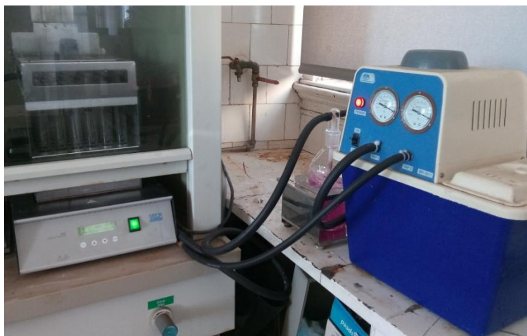
Figura 10 – Digestor utilizado para determinar o teor de azoto recorrendo ao método de Kjeldahl
