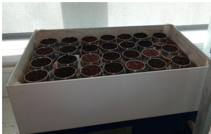
Figura 11 – Cilindros preenchidos com os substratos colocados na caixa de areia (Eijkelkamp Soil & Water, Giesbeek, Holanda).
