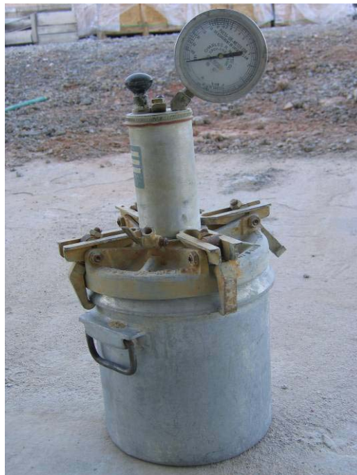
Figure 3. 5 – Air Content Test (Kao, 2005)
