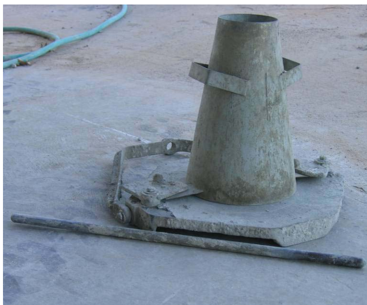
Figure 3. 4 – Slump Test (Kao, 2005)
