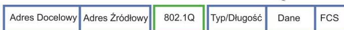
Rysunek 4 Struktura ramki Ethernet II, ramki protokołu ISL oraz standardu oznakowania IEEE 802.1Q.
