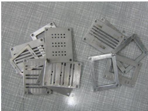
Rys. 7. Maski (po lewej) dla warstw metalicznych i uchwyt (po prawej) dla warstw organicznych w aparaturze PVD.
