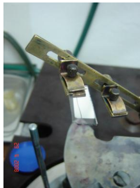
Rys. 7. Maski (po lewej) dla warstw metalicznych i uchwyt (po prawej) dla warstw organicznych w aparaturze PVD.
