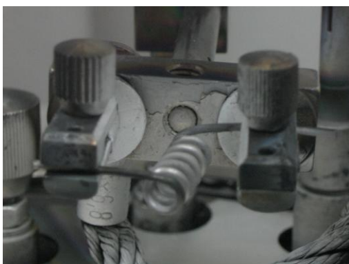
Rys. 8. Grzałka wolframowa (po lewej) i kuwetka kwarcowa z materiałem organicznym (po prawej) używane w aparaturze PVD.
