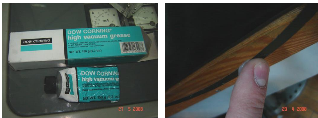
Rys. 9. Smar próżniowy (po lewej) i jego nanoszenie na brzeg klosza (po prawej).
