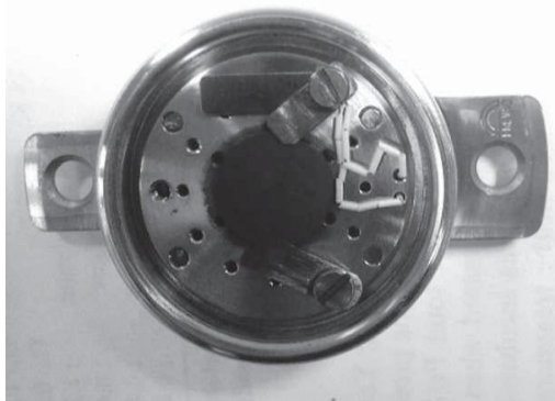
Rys. 5. Próbką katalizatora proszkowego, sprasowana w formę pastylki, zamontowana na nośniku reaktorowym.
