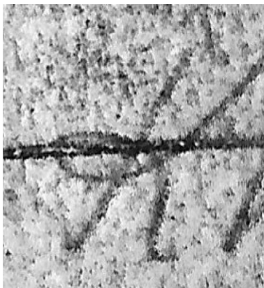
Ryc. 17. Skrzyżowanie odcisku litery „K” uwidocznionego metodą elektrostatyczną przy użyciu urządzenia ESDA 2 z poziomą linią pisma jawnego (biały fragment linii pisma jawnego przecinający ujawniony fragment zapisu reliefowego wskazuje na pierwotny zapis tego ostatniego)
