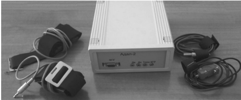
Fot. 3. Na zdjęciu prototyp poligrafu Adal ( Адап ) kazachskiej produkcji 10
