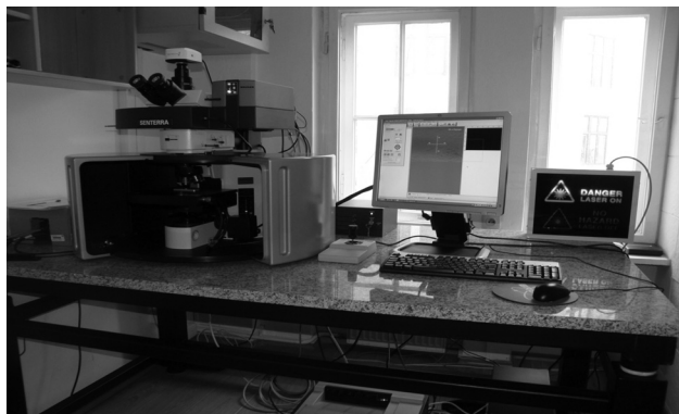
Ryc. 10. Spektrometr ramanowski w pracowni badań dokumentów wykorzystywany m.in. do badań krzyżujących i niekrzyżujących się linii pisma
