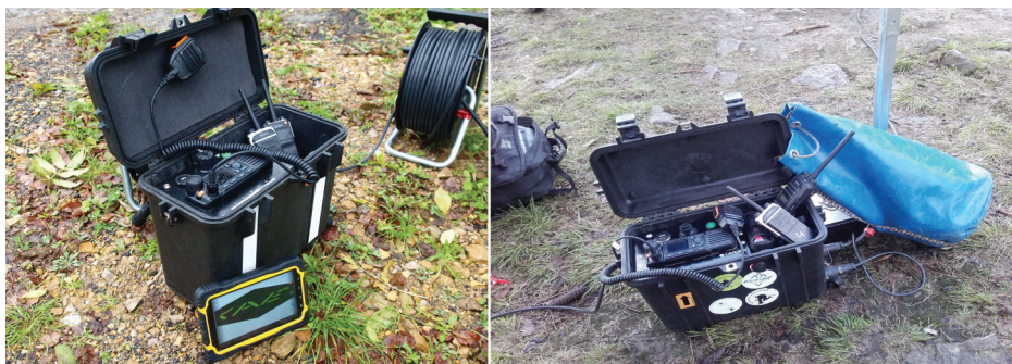
Fotografia 3. System łączności dla ratownictwa jaskiniowego pracujący z kablem LF
