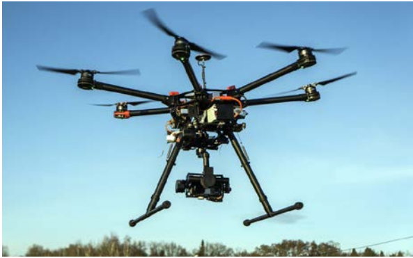
Fot. 1. Bezzałogowy system latający z kamerą termowizyjną
