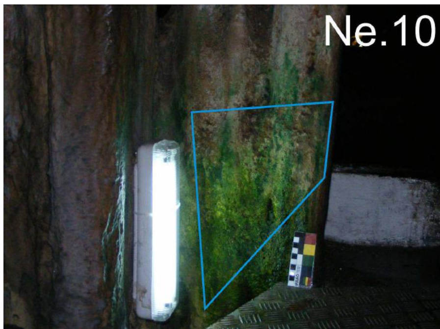
Figura 5.2i. Zona de control Ne.10, con la con la delimitación del biofilm monitorizado (1: azul ).
